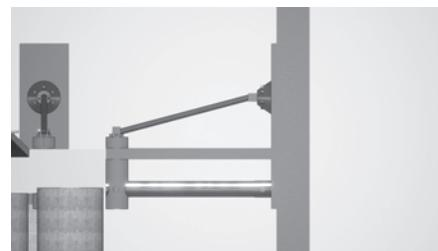
图 4 三角钢支撑剖面图
