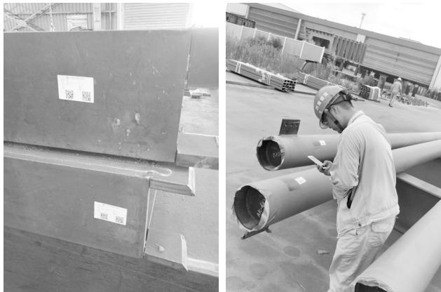
那么这一手段是如何实现的呢？首先我们阐述一下其中的原理，质量二维码实际上是在钢结构全生命期信息管理系统，也就是BIM系统的基础上，改造升级，融入了质量的相关信息，将原来传统的BIM条形码与质量二维码“合二为一”，从而实现质量信息的追溯性。当然，这离不开一个团队的分工协作，首先项目的项目管理人员需要将项目本身的信息，如项目名称、构件形式、原材信息等基本的数据录入平台，然后技术人员将信息完善升级，通过模板嵌入功能，批量生成电子版的条码，由车间专职人员打印并下发各个工段进行粘贴。
