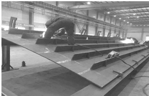
图 2 反变形工装上焊接板单元
